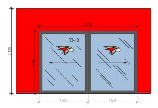
• В качестве заполнения использовать полотна из закаленного стекла без зеленого оттенка толщиной 10 мм;
